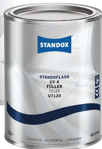
Nya Standoflash UV-A Filler U7120 torkar snabbt till full hårdhet. Beroende på torkutrustning och storlek på ytan kan torkningstiden bli så kort som tio sekunder. Att ytan kan slipas omedelbart bidrar också till att förkorta reparationstiderna.
